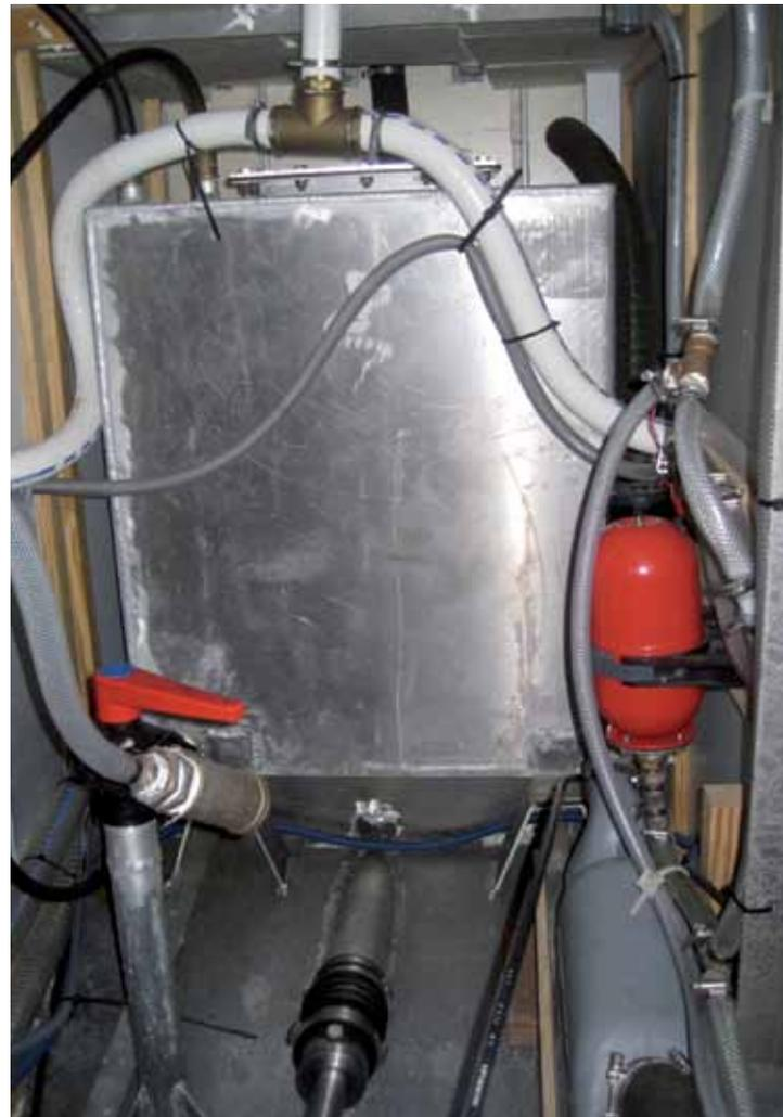
À gauche : une vue du local technique derrière le moteur. Le remplissage des réservoirs d'eau se fait par un nable unique. Le gros « bidule rouge » à droite est le vase d'expansion du circuit d'eau sous pression. On peut voir également la vanne d'arrivée d'eau de mer commune aux WC et à l'évier de la cuisine.
